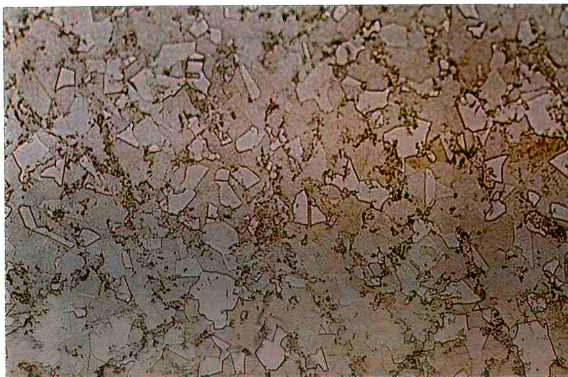
Figura 22: Liga IC-50 deformada 40% e recozida durante 1 hora a 1000°C. Ataque: Marble. Aumento 250X
