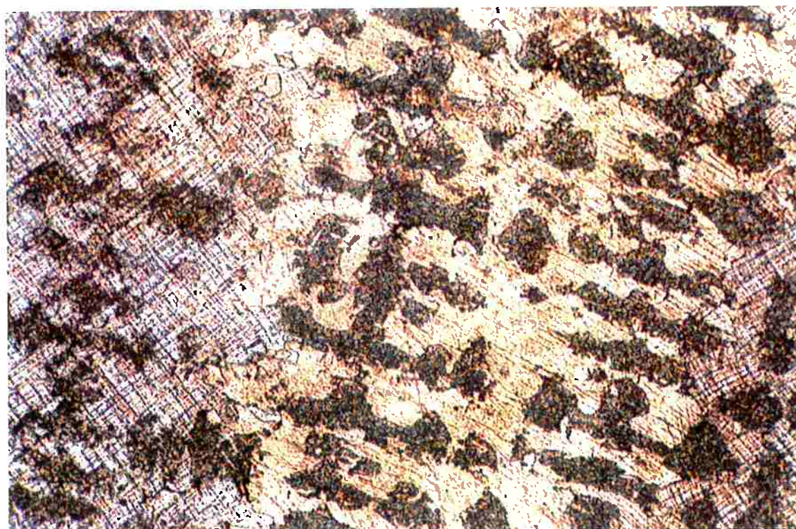
Figura 18: Liga IC-50 deformada 40%. Deformação evidenciada pela presença de linhas de escorregamento em dois sistemas de escorregamento distintos. Ataque:Marble. Aumento: 250X
